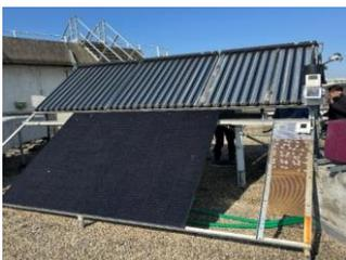
**Figure 1.** Installation photovoltaïque, station météorologique et support des plaques de verre.
